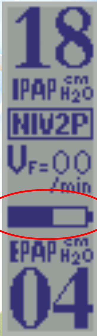
Testigo secundario de la carga de la batería
