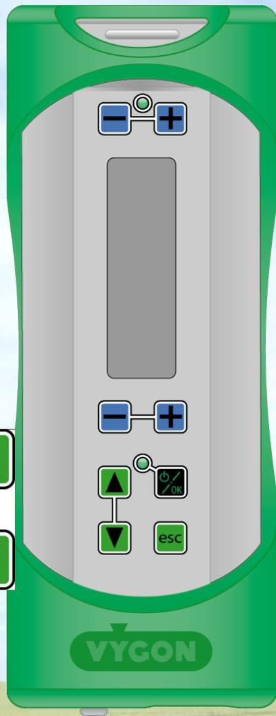
Permite navegar en los diferentes modos de Vylife (CPAP/NIV2P/Apnea / Off/ Menu)
